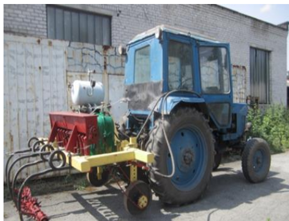
Рисунок 1 - Общий вид опытного образца агрегата для подсева семян трав с одновременным внесением растворов удобрений на луга и пастбища горной зоны
