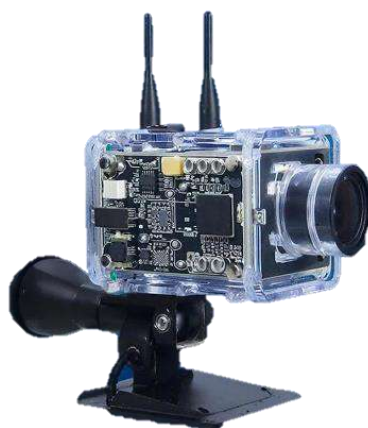
Рисунок 1 - Собранный макет камеры подводного видеонаблюдения
