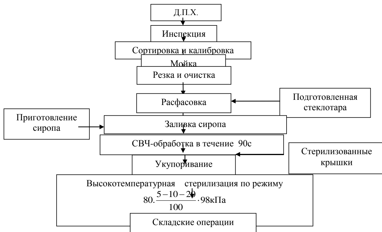
Рисунок 2 – Инновационная технологическая схема производства консервов «Компот из айвы» с использованием предварительного нагрева плодов, залитых сиропом в ЭМП СВЧ
