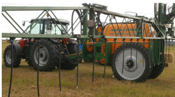
Рис.5. Агрегаты для поверхностного (опрыскивателями) и под дискование (Catros) внесения жидких удобрений КАС и ЖКУ
