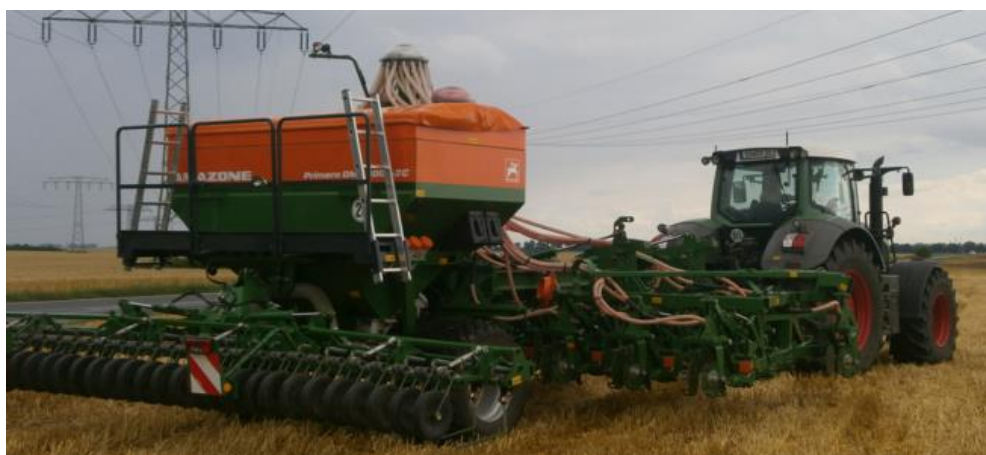
Рис. 3. Сеялка PRIMERA-DMC с шириной захвата от 3 до 12 м
