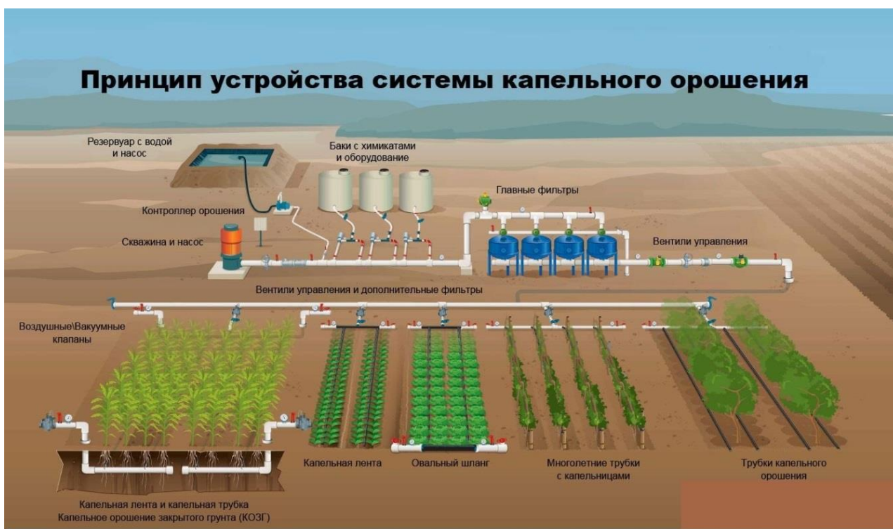
Рисунок 1- Принцип устройства системы капельного орошения.
