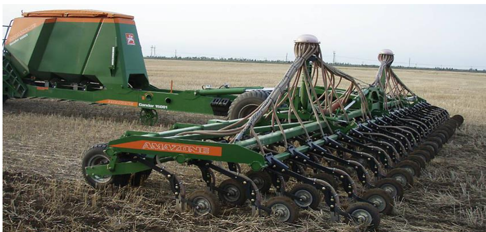
Рис. 2 Сеялка прямого посева Condor шириной захвата от 12 до 15 м
