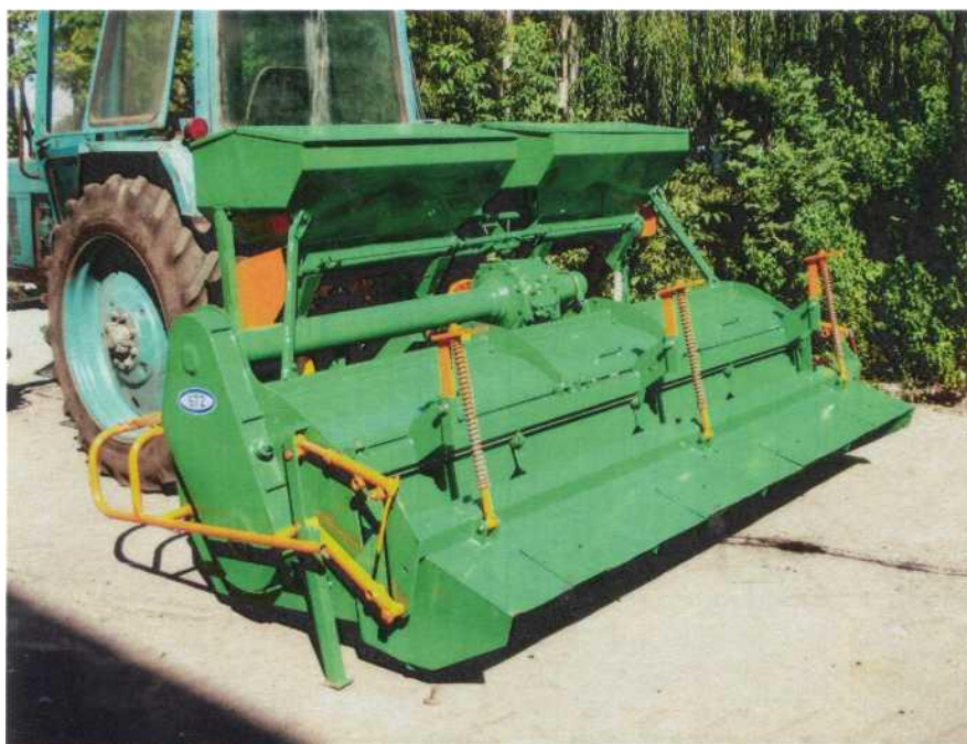
Рис. 1. Культиватор для дробно-локального внесения минеральных удобрений с фрезерной обработкой почвы для междурядий 90 см (совместная разработка ФГБНУ «ФИЦ картофеля имени А.Г. Лорха» и ИТОСХ – филиал ФГБНУ ФНАЦ ВИМ)
