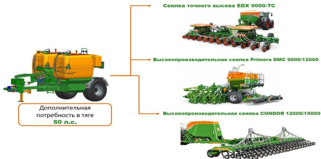
Рис.6. Агрегат FDC-6000 для внесения жидких удобрений с посевом
