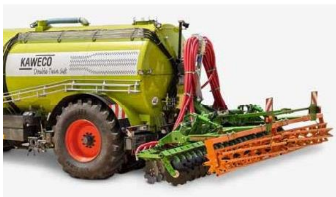
Рис.5. Агрегаты для поверхностного (опрыскивателями) и под дискование (Catros) внесения жидких удобрений КАС и ЖКУ
