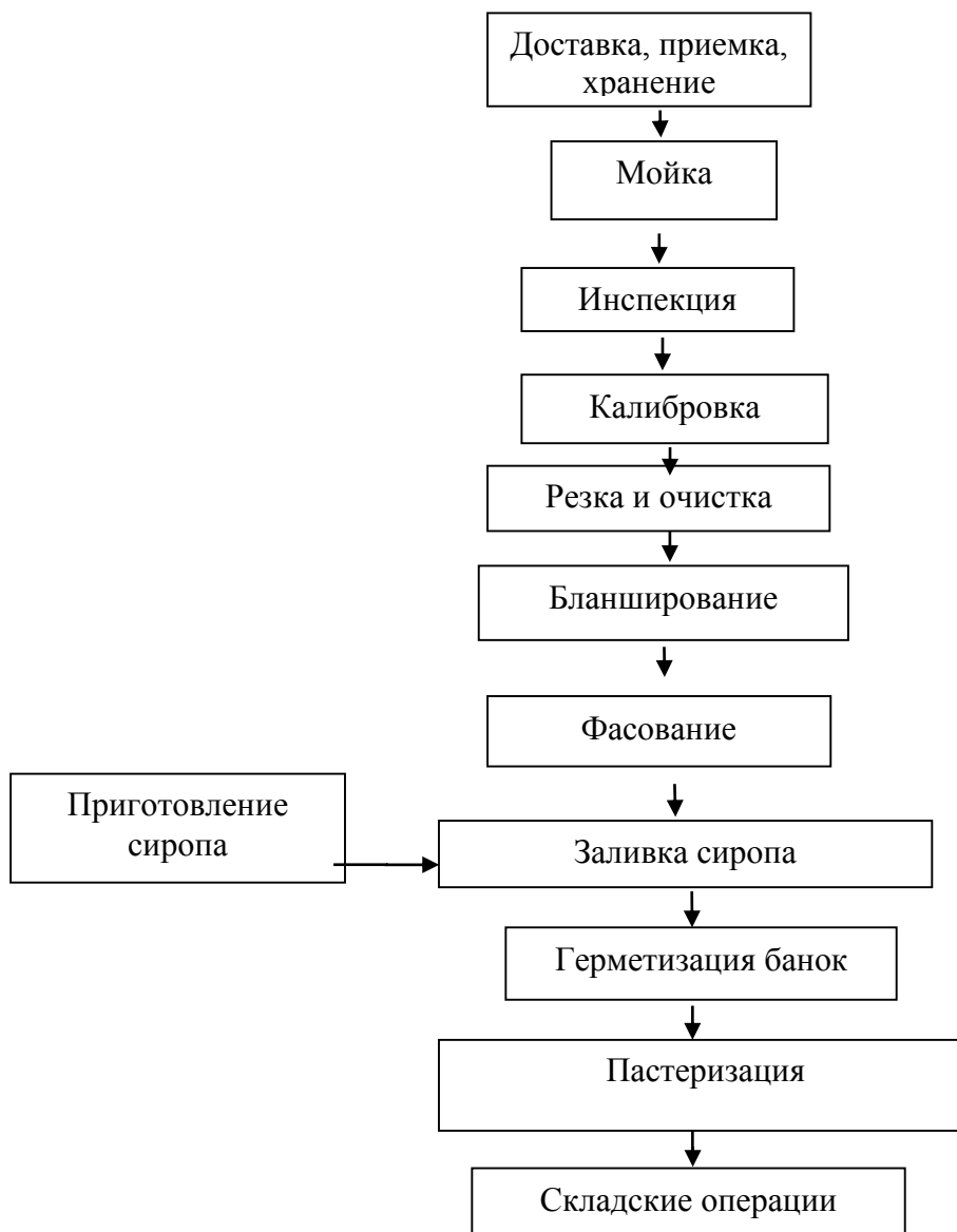
Рисунок 1.1. – Технология производства консервированных компотов из семечковых плодов по существующей технологической инструкции
