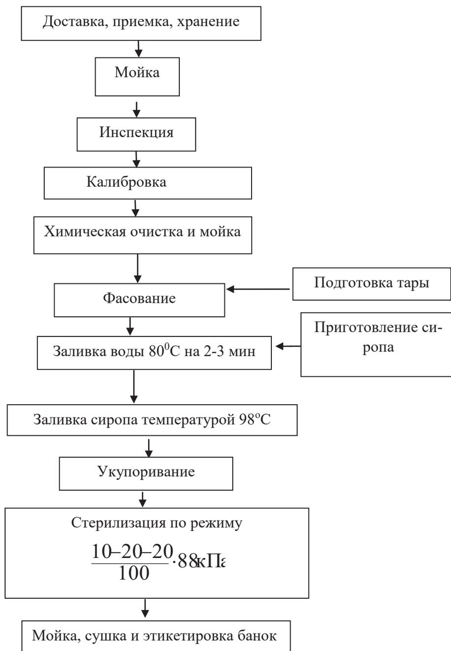
Рисунок 2 – Структурная технологическая схема производства персикового компота в стек­лобанке 1-82-500 с использованием предварительного нагрева плодов в банках горячей во­дой и ускоренной стерилизации
