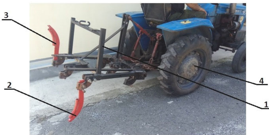
Рис.3. Лабораторный образец агрегата для щелевания деградированных горных лугов и пастбищ на базе минитрактора «Фенишоу-180»: 1 – рама агрегата; 2- рабочий орган щелереза в рабочем состоянии; 3 - рабочий орган щелереза в транспортном состоянии; 4 – минитрактор «Фенишоу -180».
