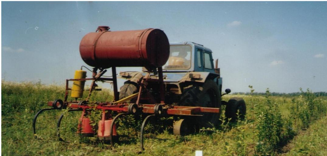
Рисунок 3 - Опытный образец агрегата на базе чизельного культиватора КЧГ-2,4 конструкции СКНИИГПСХ
