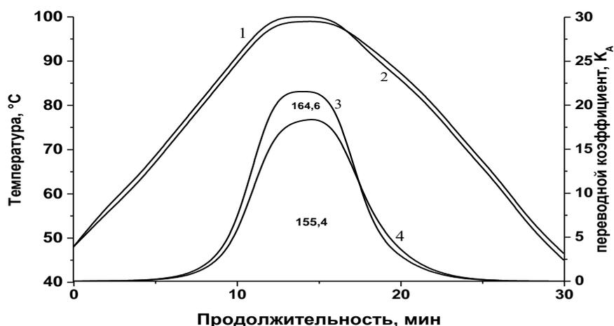
Рисунок 2 - графическое изображение изменения температурного уровня (1,2) и подавления микрофлоры (3,4) в пристеночной (1,3) и серединной (2,4) областях компота из винограда при стерилизации по новому высокотемпературному трехуровневому режиму нагрева и охлаждения
